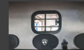
Schuifraam met tralies tussen cabine en het paardengedeelte
