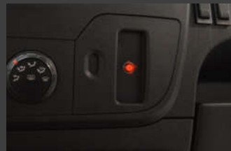
Waarschuwingssysteem voor open oploopklep, bovenklep of achterdeur.
